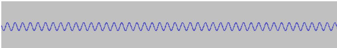
Der Ausschnitt oben zeigt die Schwingung einer Stimmgabel für eine Zehntelsekunde (von Sekunde 1.7 bis Sekunde 1.8s).
