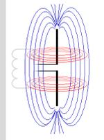
In dieser Stunde haben wir untersucht, was passiert, wenn man aus einem Schwingkreis-Kondensator eine Antenne formt. Das Ergebnis ist erstaunlich! Man hat einen Sender (oder Empfänger) von elektromagnetischen Wellen.
