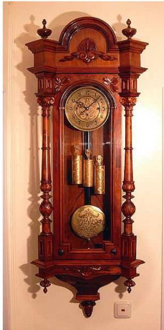
Um die unerwünschte Reibung zu eliminieren, wird durch eine komplizierte Mechanik immer etwas Energie zugeführt. Dazu dienen die im Bild gut sichtbaren Gewichte. Die potentielle Energie, die in ihnen „gespeichert“ ist (sie senken sich nach und nach ab und müssen bei Zeiten wieder hochgezogen werden), reicht gut aus, um die durch Reibung verlorene Energie zu kompensieren!
