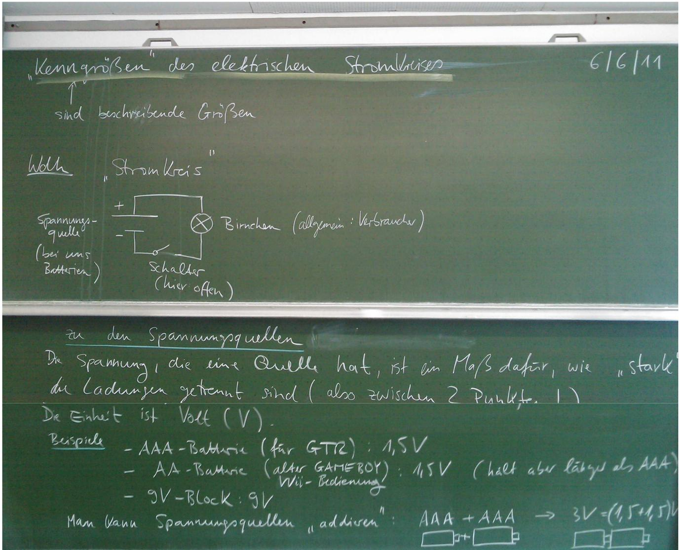
Neben der Spannungsquelle, die den Stromkreis „antreibt“, also die Ladungen zum „Fließen“ bringt, ist noch die Stromstärke von großer Bedeutung. Darüber erfahrt ihr mehr in der GFS „Gefahren des elektrischen Stroms“ und danach notieren wir hierzu die wichtigsten Dinge!
