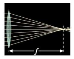
Diesen Punkt nennt man den **Brennpunkt** und der Abstand von der Linsenachse (dem senkrechten Strich durch die Mitte der Linse) ist in diesem Bild (wie das oben aus Wikipedia) mit f bezeichnet und heißt Brennweite.
