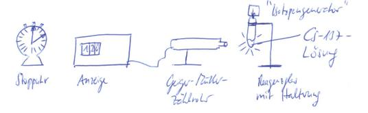
Wir notieren uns nun alle 30 Sekunden den aktuellen Zählerstand unseres Messgerätes für etwa 8 Minuten. Hier müssen wir uns noch klar machen, dass wir so auch indirekt die Zerfälle messen. Denn: die Lösung im Reagenzglas wird in alle Richtungen gleichmäßig Gammastrahlen abgeben. Wir messen zwar nur einen kleinen Ausschnitt (nämlich alle Strahlung die zufällig in unser Zählrohr geht), aber der ist repräsentativ! Es gilt sozusagen:
